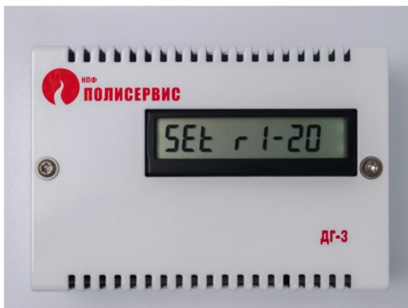
Рисунок 1.7 - Реле тревоги срабатывает при пороге 20 млн -1
