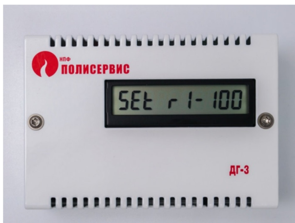
Рисунок 1.8 - Реле тревоги срабатывает при пороге 100 рт
